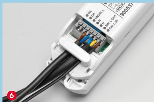
6 Branchez le câble de secteur sur le driver LED de secours (conducteur neutre et ligne non commutée) et fixez les câbles avec la bride de décharge.
