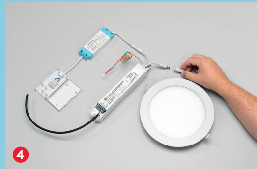
4 Schließen Sie das Emergency Kit zwischen den Zoe LED Treiber und die Leuchte.
